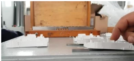
Фиг. 2.6 Отклонение от равнинност 5 мм при зададено по чертеж 0,4 мм.
