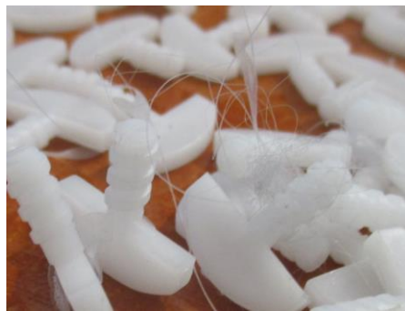
Фиг. 2.8 Характерни „косми“, получаващи се при шприцване на материал POM.
