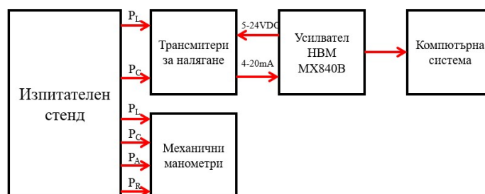
Фиг. 3.1 Структурна схема на измервателната система.
