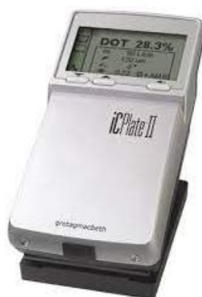
Фиг. 3 Уред за измерване на печатни форми-litho plate meter IC plate 2 gretagmacbeth
