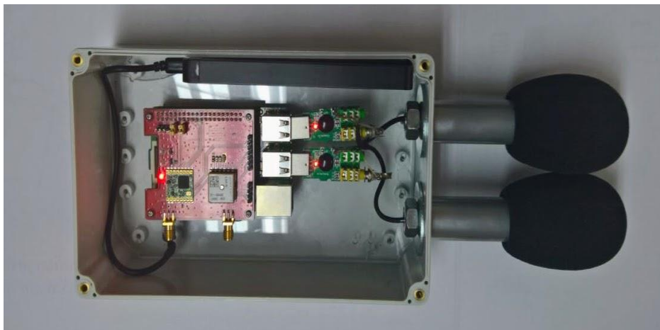
Фиг. 5.6 Хардуерни компоненти на сензорния модул
