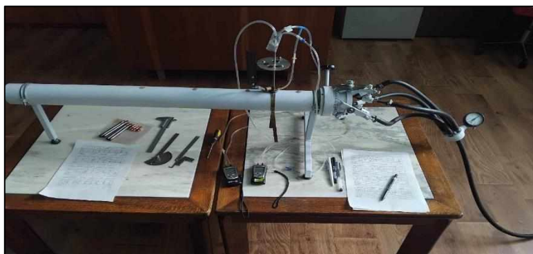
Фиг. 5.2. Снимки на експериментална инсталация за изследване на аеродинамиката на инжектирана завъртяна струя.
