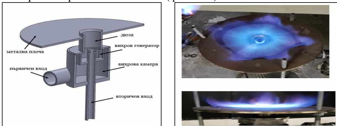
Фиг. 1.19. Изглед на модулна вихрова горелка и изображение на стабилен пламък на Коанда [74], [73].
