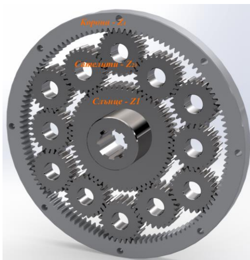
Фиг. 1.3. Зъбен механизъм с взаимно зацепени сателити A[A]I
