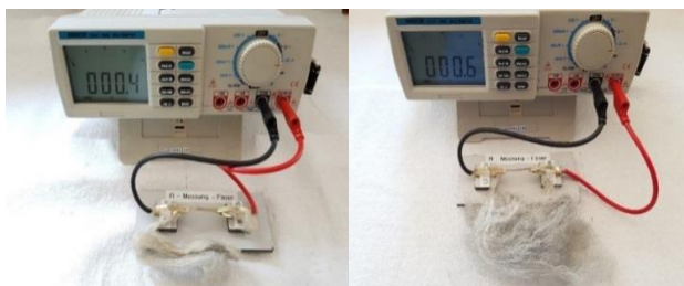
Фиг. 7.49, Измерване на електрическото съпротивление на полиестерни влакна преди прането (в ляво) и след прането (в дясно)
