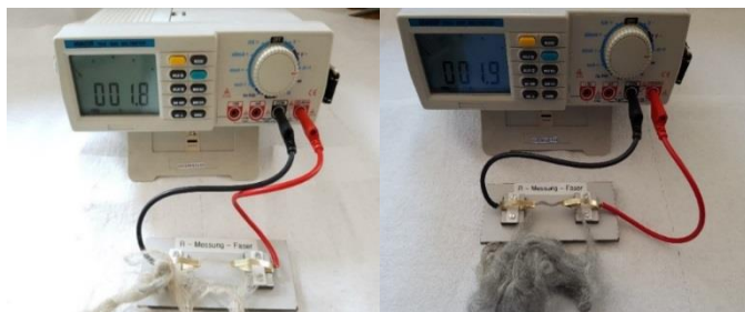
Фиг. 7.54, Измерване на електрическото съпротивление на полиестерни влакна преди (в ляво) и след (в дясно) ултразвуковия тест
