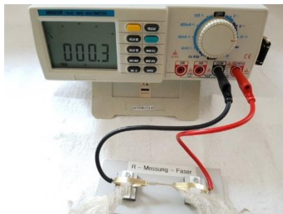
Фиг. 7.31, Измерване на електрическото съпротивление на нишка от полиестерни влакна
