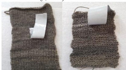
Фиг. 7.42, Тиксо тест върху вълнено (ляво) и полиестерно (дясно) платно
