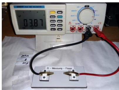
Фиг. 7.28, Измервателен стенд за единични влакна със златни щипки
