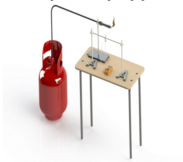
Фиг. 3.7. Примерна схема за измерване температурата на факела при инжекционна горелка
