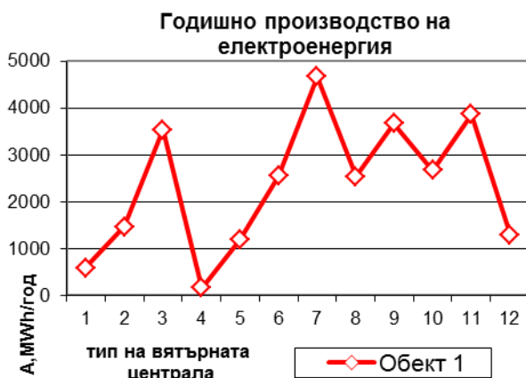
Фиг.1.1. Количество произвеждана електроенергия за една година A, \text{MWh/g} от вятърна централа при средногодишна скорост на вятъра 4,3 m/s
