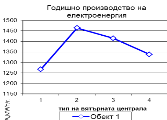
Фиг.1.3. Годишно производство на електроенергия от три различни типа вятърни централи с единична мощност 800 kW при средногодишна скорост на вятъра 4,3 m/s
