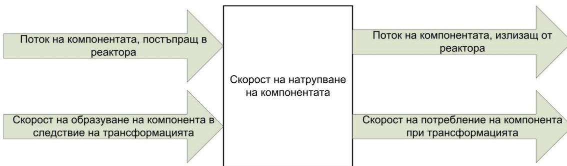
Фиг. 1.11. Масов баланс по отношение на i -тия компонент, подложен на анаеробно разграждане
