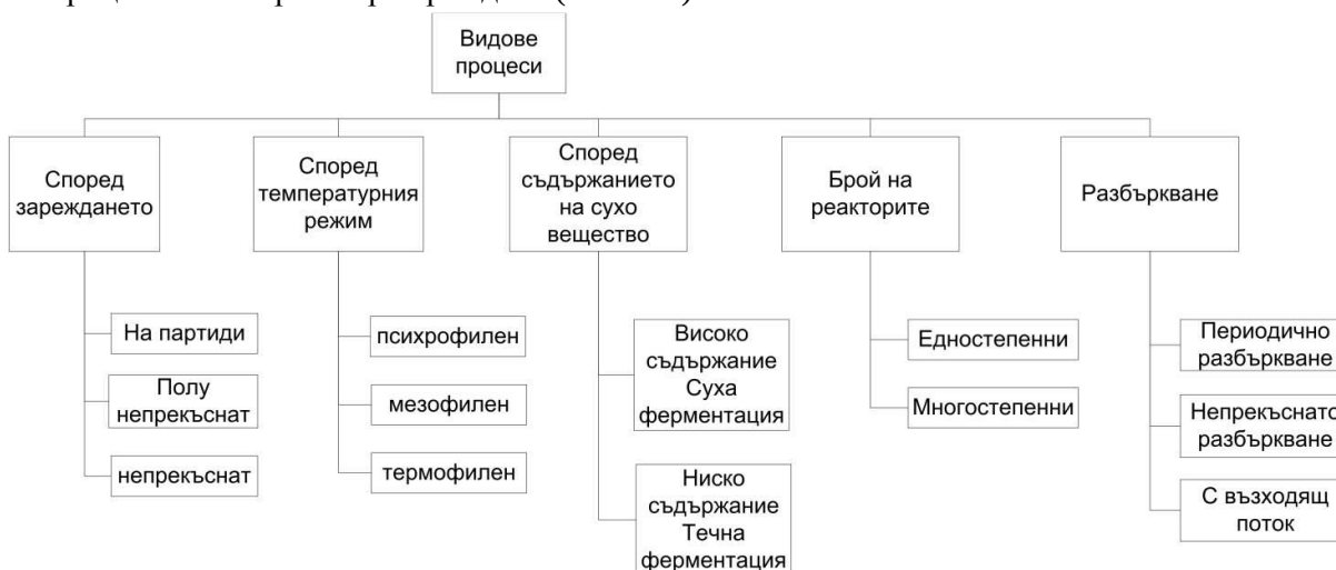
Фиг. 1.4 Класификация на биогазовите инсталации
