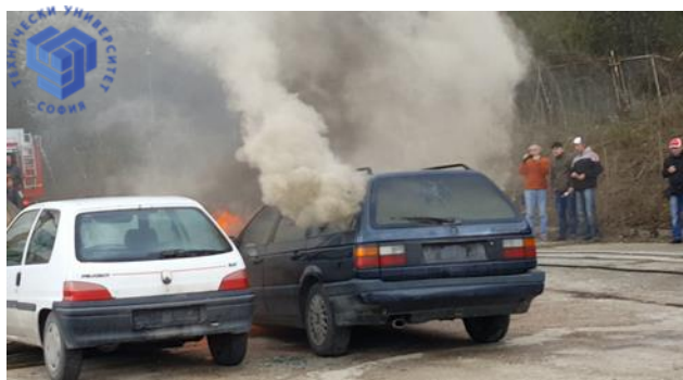
Фиг. 2.21 Интензивността на газообмена при отстраняване на заден десен прозорец на 60 min от стартиране на пожара
