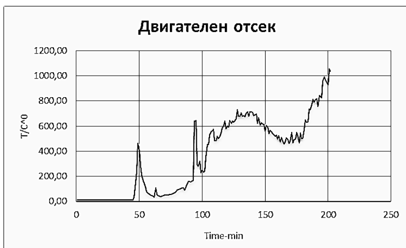
Фиг.2.17 Измерени температури в двигателния отсек в затворен капак.
