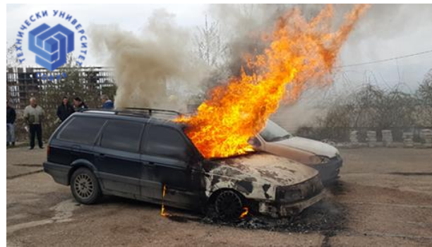
Фиг. 2.21 Интензивността на газообмена при отстраняване на заден десен прозорец на 60 min от стартиране на пожара
