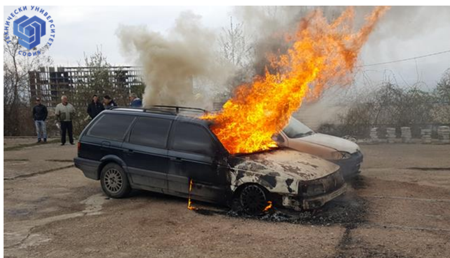
Фиг. 3.11. Движение на конвективни потоци при наличие на вятър. Експериментална постановка – Технически университет
