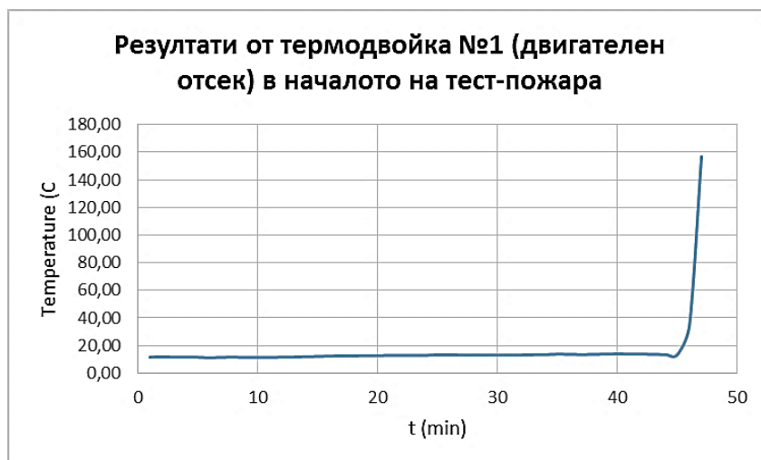
Фиг. 2.15 Измерени температури в двигателния отсек в началото на теста
