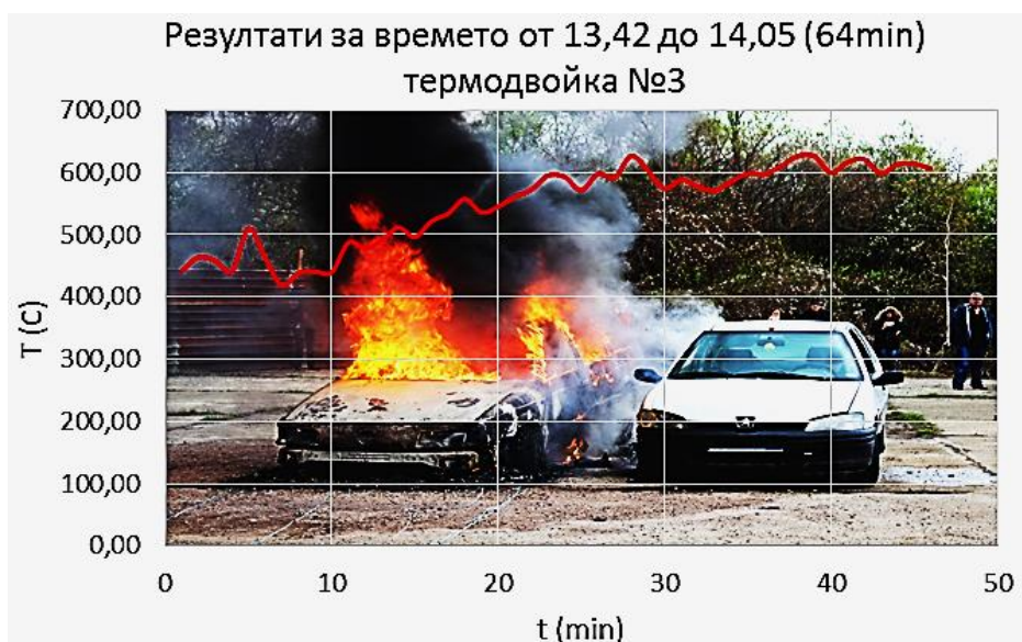
Фиг.2.25 Температура на експеримент (пожар) на предно стъкло
