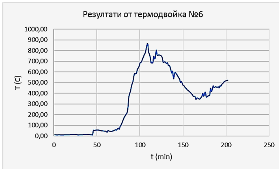
Фиг. 2.32 Резултати от измерване на температурата от горящия автомобил, към разположен в близост друг автомобил..
