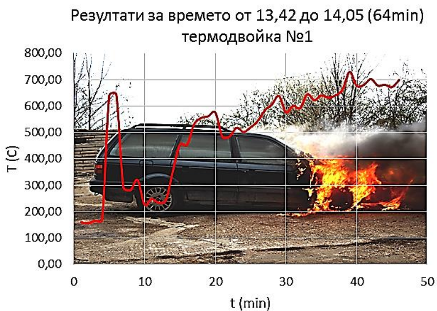
Фиг. 2.23 Температура на експеримент (пожар) в двигателен отсек
