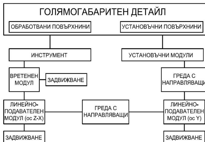
Фиг. 5.3. Структурна схема на мобилна металоуреждаща машина за фрезове на канал
