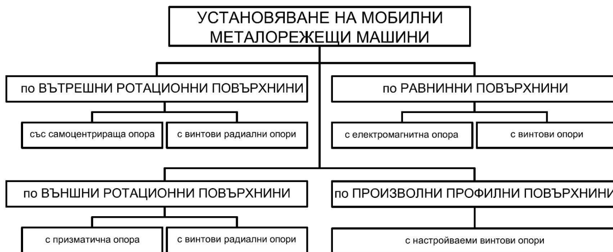
Фиг. 2.2. Класификация на мобилните металорежещи машини според начина на установяване
