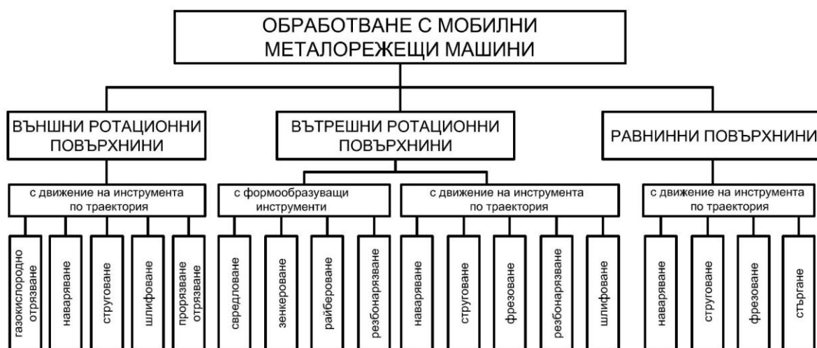
Фиг. 2.1. Класификация на мобилните металорежещи машини според метода за обработване
