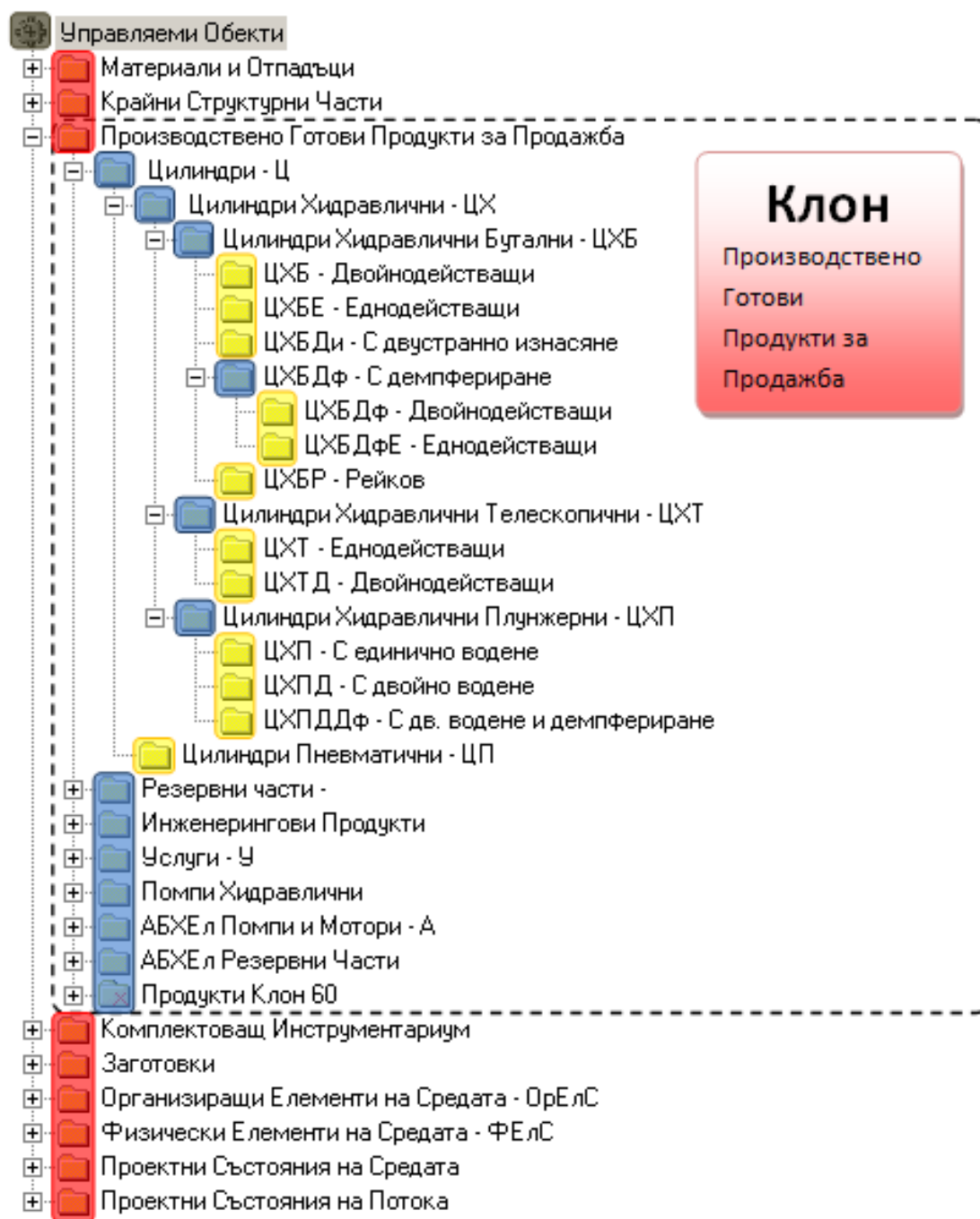
Фиг. 4.4. Класификационна схема на хидравличните цилиндри, изработвани в ХЕС АД
