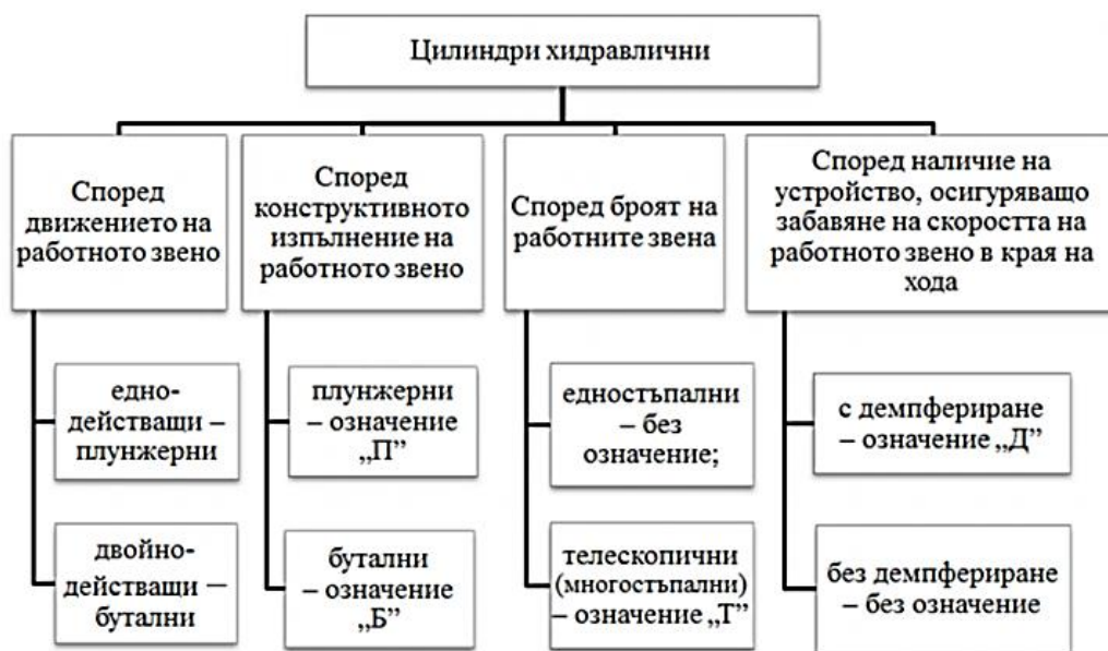
Фиг. 2.3. Цилиндри хидравлични - класификация и означения [15]
