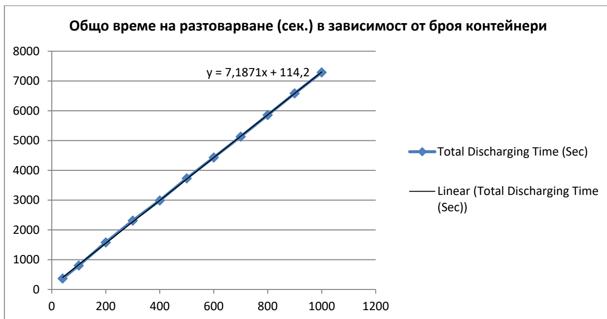
Фиг. 3.40. Графика на линейната функция y=7,1871x + 114,2 , показваща зависимостта между промяната в броя контейнери и промяната в общото време на разтоварване
