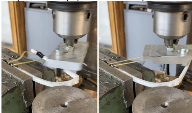
Фиг. 5.32 Установка за циклично натоварване на еластична панта
