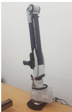
Фиг. 5.14 3D скенер Romer absolute arm 7320 SI
