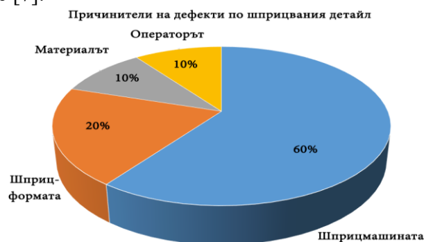
фиг. 1.1 Причина за дефекти при шприцване [16]
