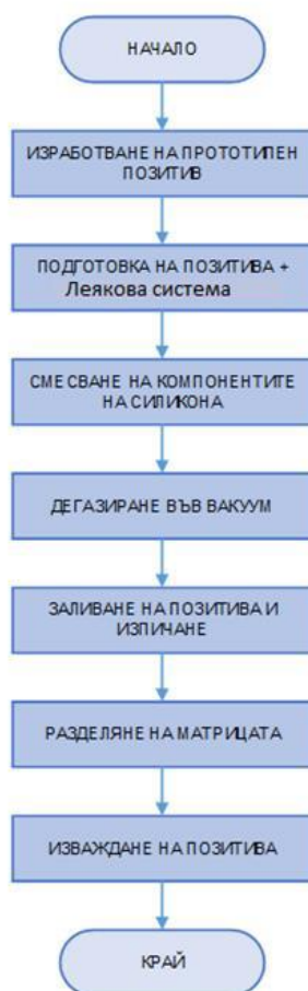
фиг. 2.6 Последователност при изработване на силиконова матрица
