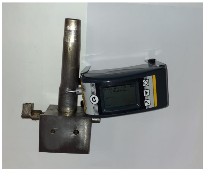
фиг. 5.5 Провеждане на измерване на грапавост на повърхнини при образец „поансон“
