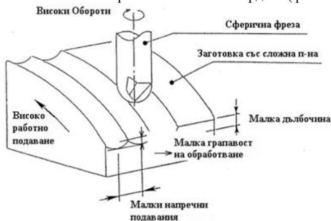
фиг. 1.1 HSM обработване на сложна повърхнина от формообразуващ инструмент
