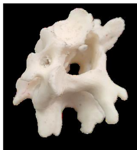
фиг. 2.7 Репликация на гръбначен преилен, произведен, чрез лееие в силиконова матрица
