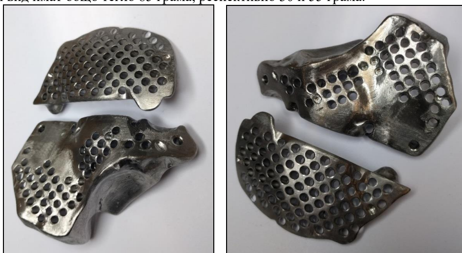
фиг. 2.12 Двете части на импланта в крайния си вид след механични довършителни операции
