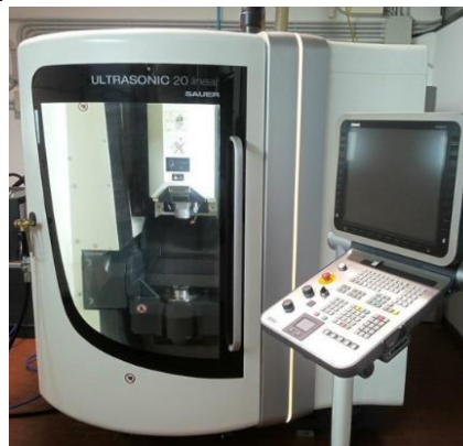
Фигура 10-12: Многофункционален обработващ център за изготвяне на импланти от твърди и свръх твърди материали.
