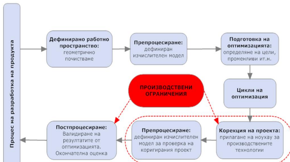
Фигура 4-43: Процес на решаване на числени оптимизационни задачи
