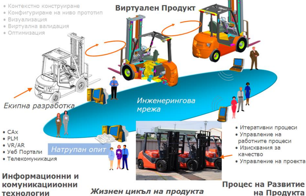
Фигура 9-101: Жизнен цикъл на фамилия високоповдигачи (мотокари) при използване на подходи от виртуалното инженерство
