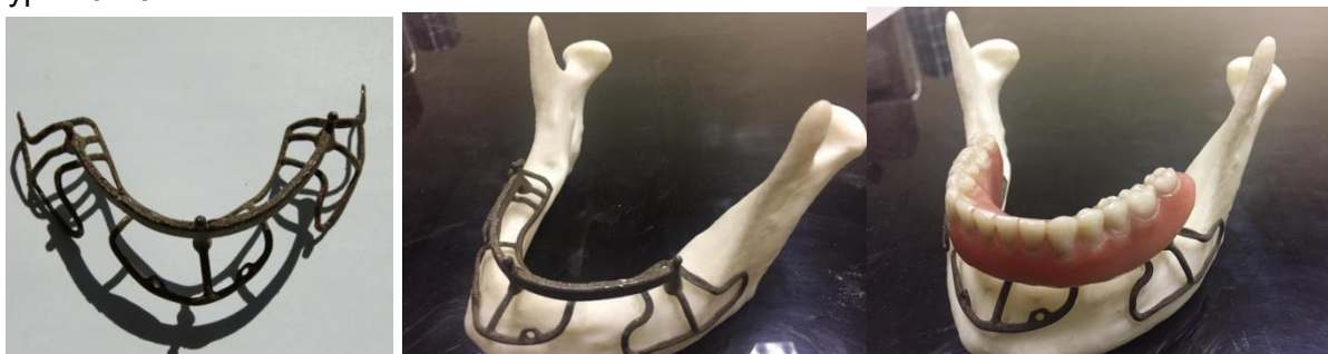
Фигура 10-46: Снимка на физически изготвен субпериостален имплантат, разположен върху прототип на мандибулната челюст също създадена чрез адитивна технология – отлагане наразтопен материал(FDM) – от материал ABS.
