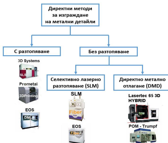
Фигура 5-8: Някои методи за адитивно изграждане на компоненти от метал
