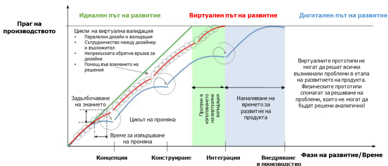
Фигура 2-32: “Дизайн–тест” с използване на виртуалното инженерство (according to automotive engineering), (Ovtcharova, 2010)
