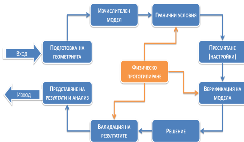
Фигура 7-2: Етапи на изграждане на модел на провеждане на инженерен анализ и място на физическото прототипиране
