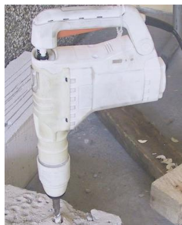
Фигура 9-70: Функционален физически прототип на машина от среден клас–перфоратор BP540CE
