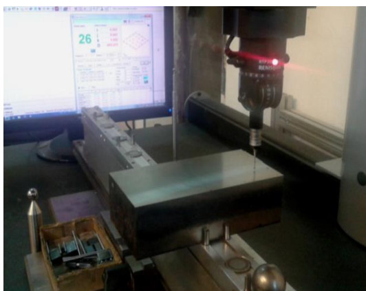
Фиг.4.22 Опитна установка за измерване на отклоненията от равнинност \Delta p
