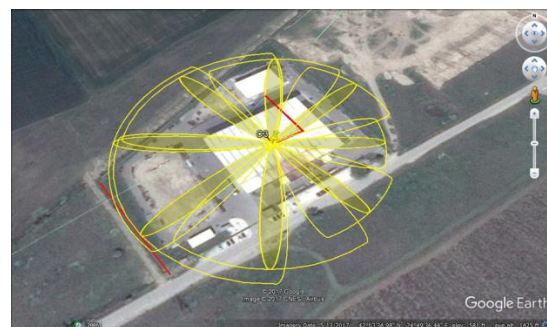
Фиг. 25, 26. Териториално разпространение при предполагаемо изпускане на LPG в атмосферата вследствие събитие със загуба на херметичността, януари, юли
