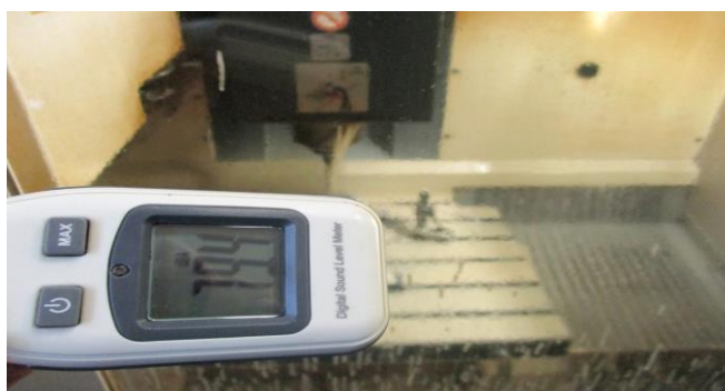
Фиг. 4.23. Измерване на шум на металорежещата машина
