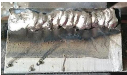
Фиг. V.2.1 Пробен образец при наваряване (МИГ) върху подложка с предварително нанесен филм, съдържащ никелирани микро SiCp, плакирани с флюс
