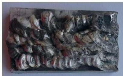
Фиг. V.2.1 Пробен образец при наваряване (МИГ) върху подложка с предварително нанесен филм, съдържащ никелирани микро SiCp, плакирани с флюс
