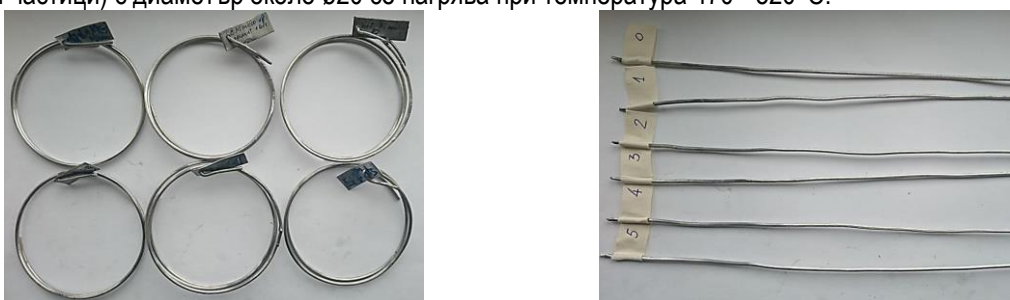
Фиг. VI.1.8. Снимки на получения чрез екструдирание добавъчен материал (тел)
