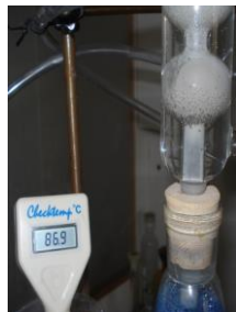
Фиг. II.2.4. Помедняване на предварително никелирани SiCp
