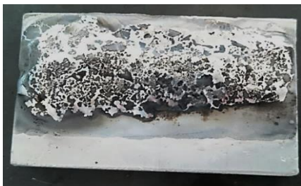
Фиг. V.2.2 Пробен образец по време на процеса на наваряване (ВИГ) върху подложка с предварително нанесен филм, с никелирани микро/ нано SiCp, плакирани с флюс
