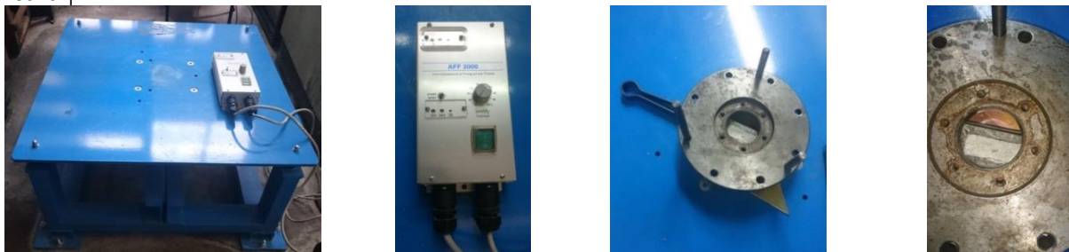
Фиг. IV.3.5. Вибрационен стенд за стръскване на насипни материали Matest S238-10
