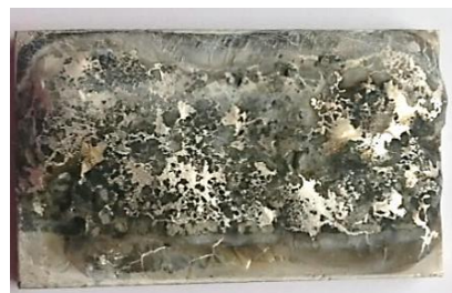
Фиг. V.2.2 Пробен образец по време на процеса на наваряване (ВИГ) върху подложка с предварително нанесен филм, с никелирани микро/ нано SiCp, плакирани с флюс
