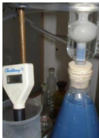
Фиг. II.2.4. Помедняване на предварително никелирани SiCp
