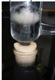
Фиг. 11.2.2. Никелиране на неметални микро SiCp при нагряване
