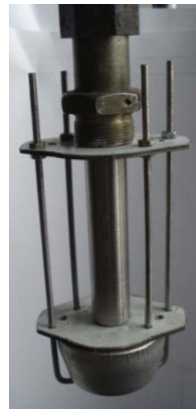
Фиг. IV.2.3. Вертикална бъркалка без и със стопяема чашка
