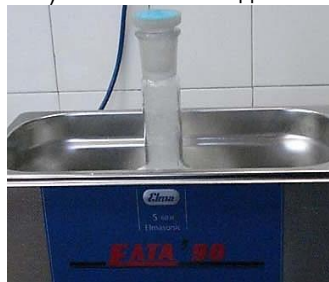
Фиг. 11.2.3. Никелиране на неметални нано SiCp в ултразвукова вана
