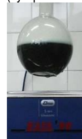
Фиг. 11.2.3. Никелиране на неметални нано SiCp в ултразвукова вана
