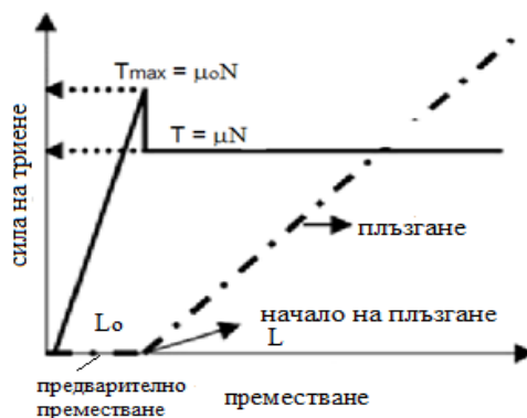
Фиг. 4.3. Универсална крива на изменение на силата на триене от тангенциалното преместване
