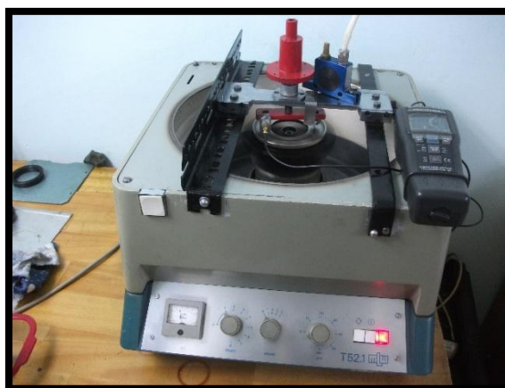
Фиг. 5.35. Снимка на триботестер за изследване на износването при високи скорости в условия на гранично триене
