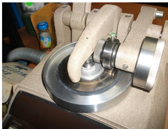
Фиг. 4.38. Снимка на триботестер за изследване на износването при сухо триене с малка скорост на плъзгане
