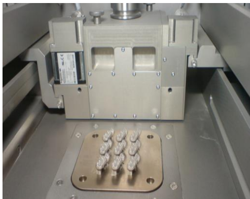
Фиг. 5 Готовите модели, почистени от необработения материал
