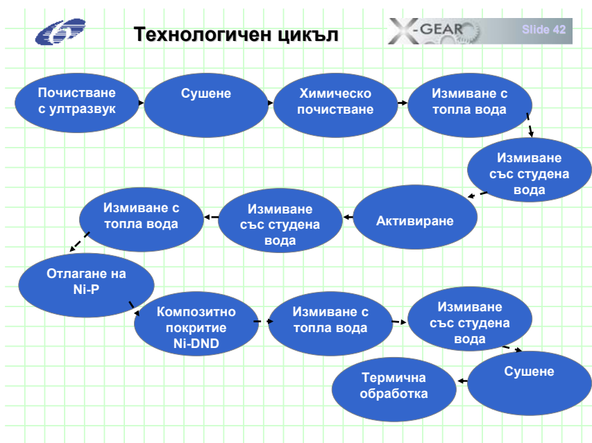
Фигура 11. Технологичен цикъл на процеса на отлагане на композитно никелово покритие.
