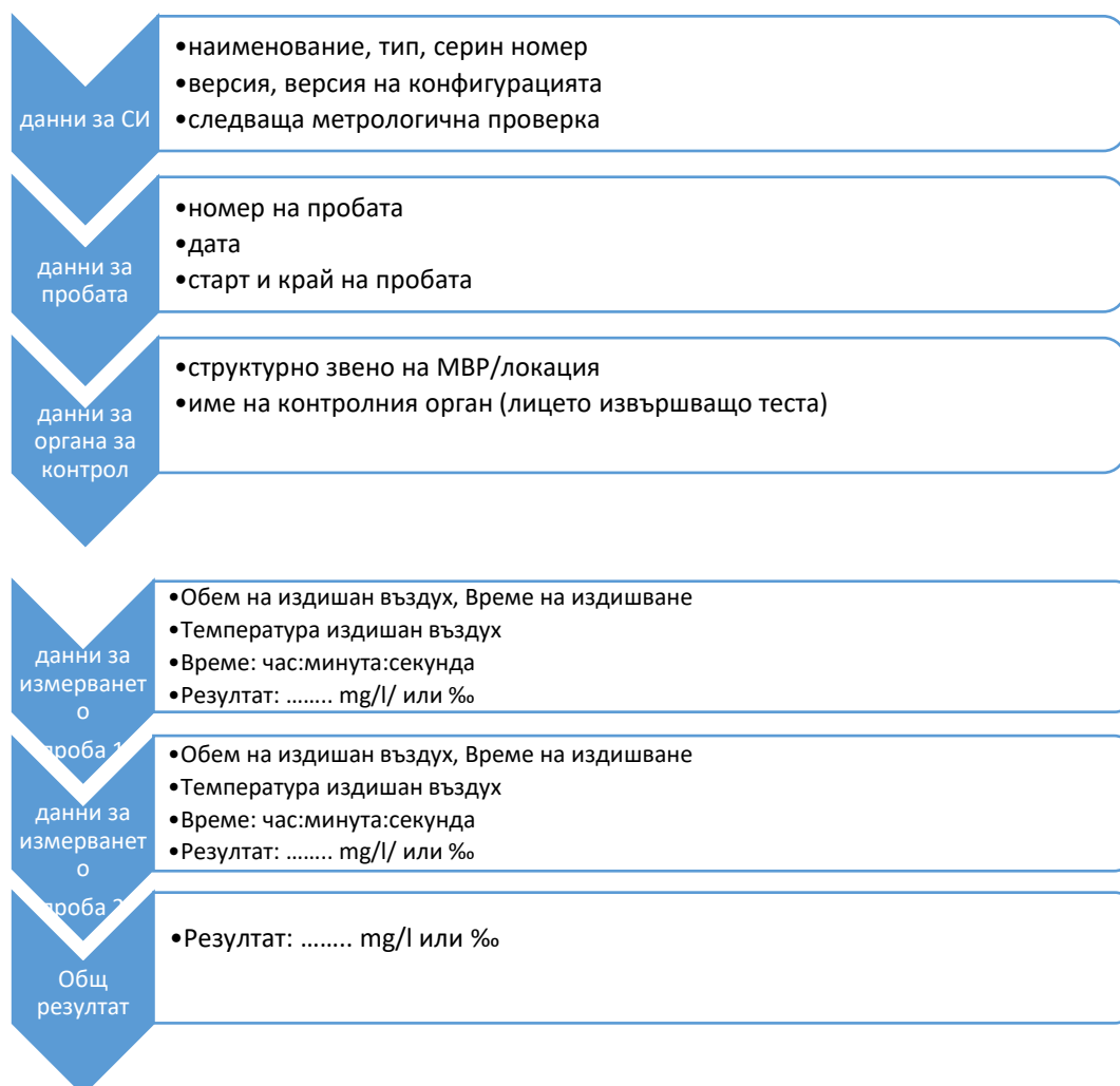
Фиг. 4.1 Информацията която постъпва от анализатора за алкохол в дъха към базата данни
