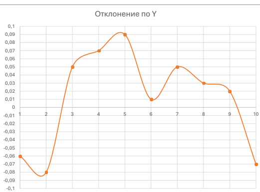
Фиг.6.4. Отклонение на позицията по ос Y след всеки цикъл
