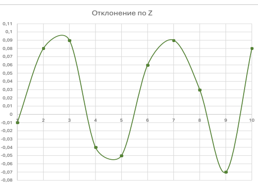
Фиг.6.5. Отклонение на позицията по ос Z след всеки цикъл
