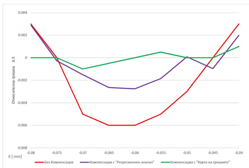
Фиг.3. 7. Графика на относителната грешка на IBR-ae-1 без софтуерна компенсация и след въвеждането на компенсация чрез регресионен анализ и след въвеждането на „карта на грешките“
