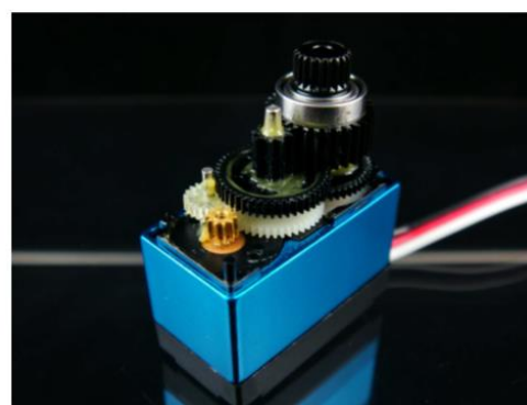
Фиг.4.6.Двигател Mirco Servo HD-1581HB на компанията Power HD.[32]
