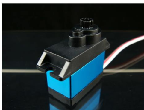
Фиг.4.6.Двигател Mirco Servo HD-1581HB на компанията Power HD.[32]
