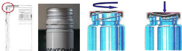
Фиг. 2.15 Деформиране на капачката от завалцоване и от термична обработка
