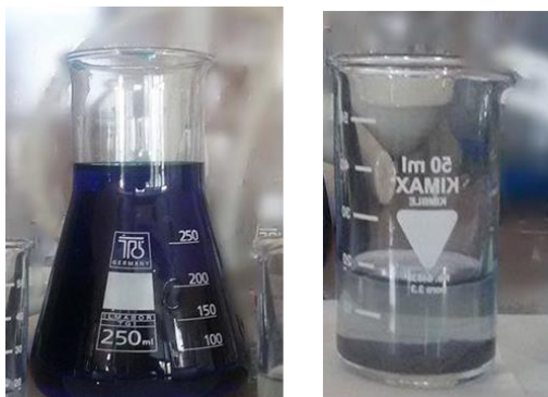
Фигура 16. Обезцветяване на вода, замърсена с метиленово синьо
