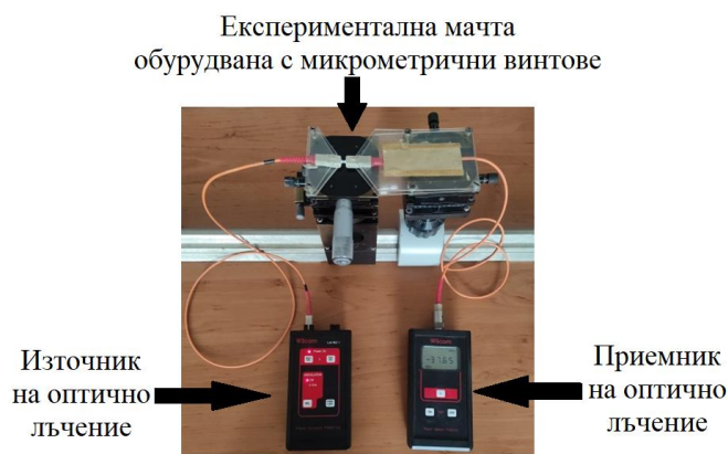
Фиг.2.5. Опитна постановка на реален експеримент за аксиално и странично отместване на многомодови оптични влакна
