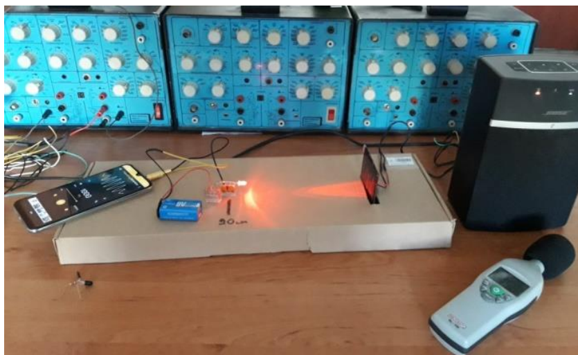
Фиг.3.12. Експериментална опитна постановка за изследване на различни светодиоди при разстояние 20 см между източник и предавател и честота 1 kHz
