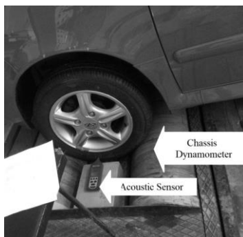
Фиг.4.1. Експериментална обстановка за измерване на шума при контакта на автомобилна гума с пътната настилка
