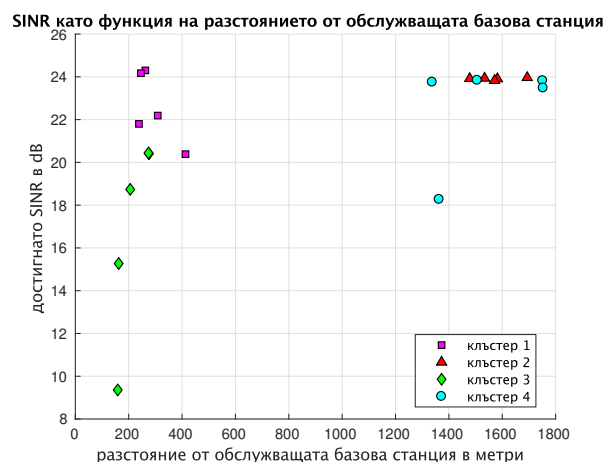
Фигура 2.21: Достигнато SINR за всеки потребител от мрежата като функция на разстоянието от обслужващата BS при модел на канала Okumura-Hata за градска среда и честота на носещия сигнал f = 1 GHz [A3].
