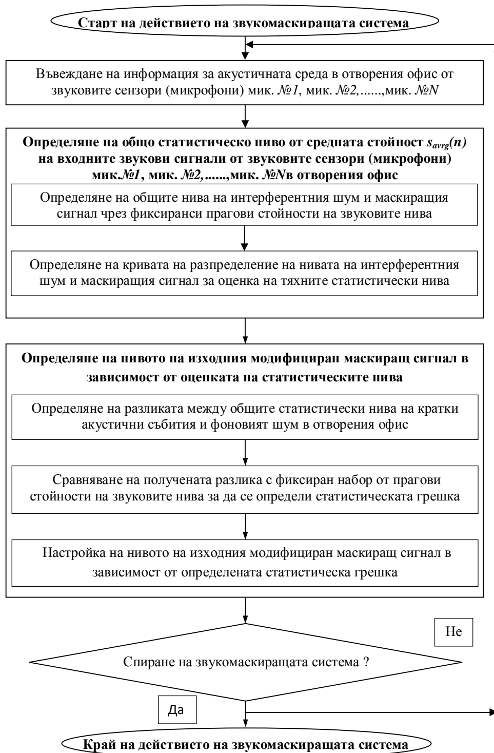
Фиг. 3.3. Алгоритъм за моделиране на маскиращ сигнал в звукомаскиращите системи
