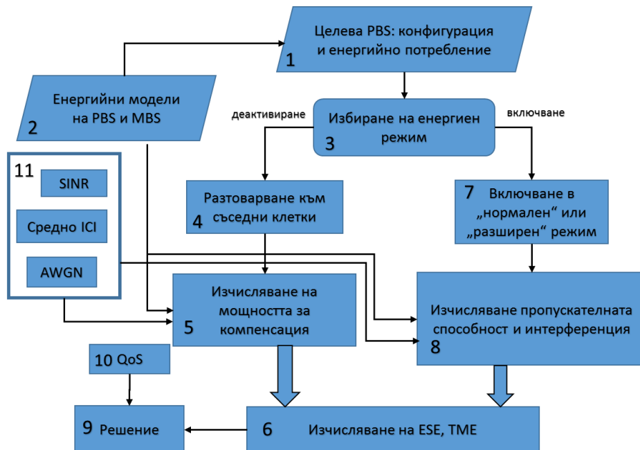
Фигура 4.20 Блокова схема за максимизиране на пропускателната способност с енергийна ефективност
