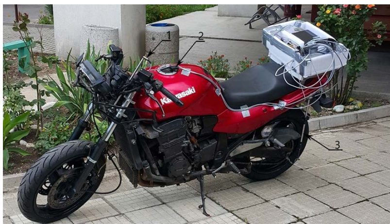
Фиг. 2.1. Мотоциклет Кавасаки, оборудван с измервателна апаратура
