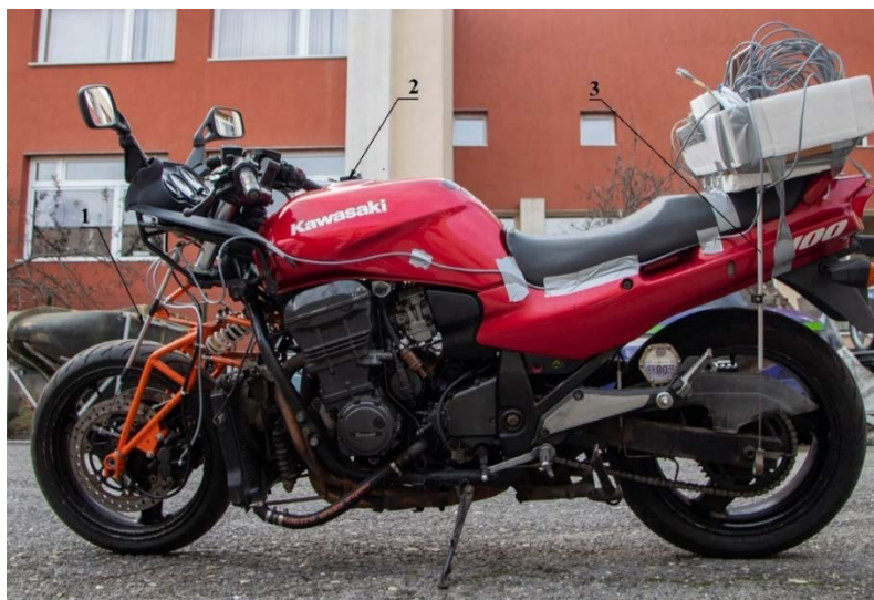
Фиг. 4.2. Мотоциклет Кавасаки, оборудван с многолостово окачване и измервателна апаратура
