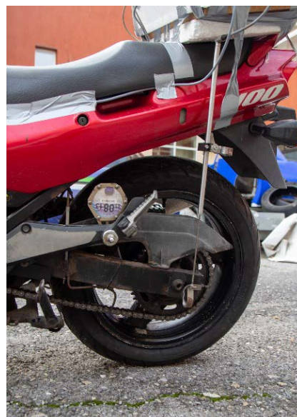
Фиг. 4.2. Мотоциклет Кавасаки, оборудван с многолостово окачване и измервателна апаратура
