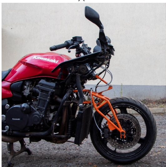
Фиг. 3.24. Сглобен прототип на многораменно предно окачване на мотоциклет, изглед отдясно
