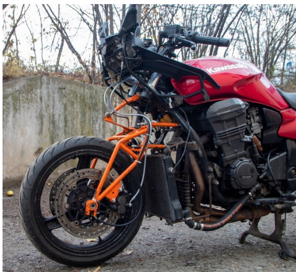
Фиг. 3.23. Сглобен прототип на многораменно предно окачване на мотоциклет, изглед отляво
