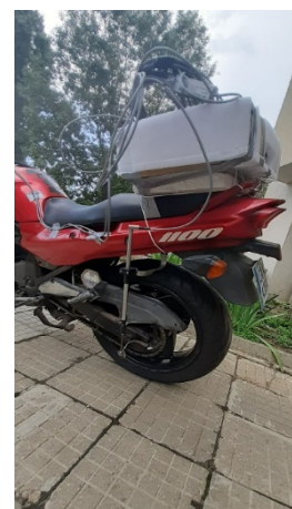
Фиг. 2.1. Мотоциклет Кавасаки, оборудван с измервателна апаратура
