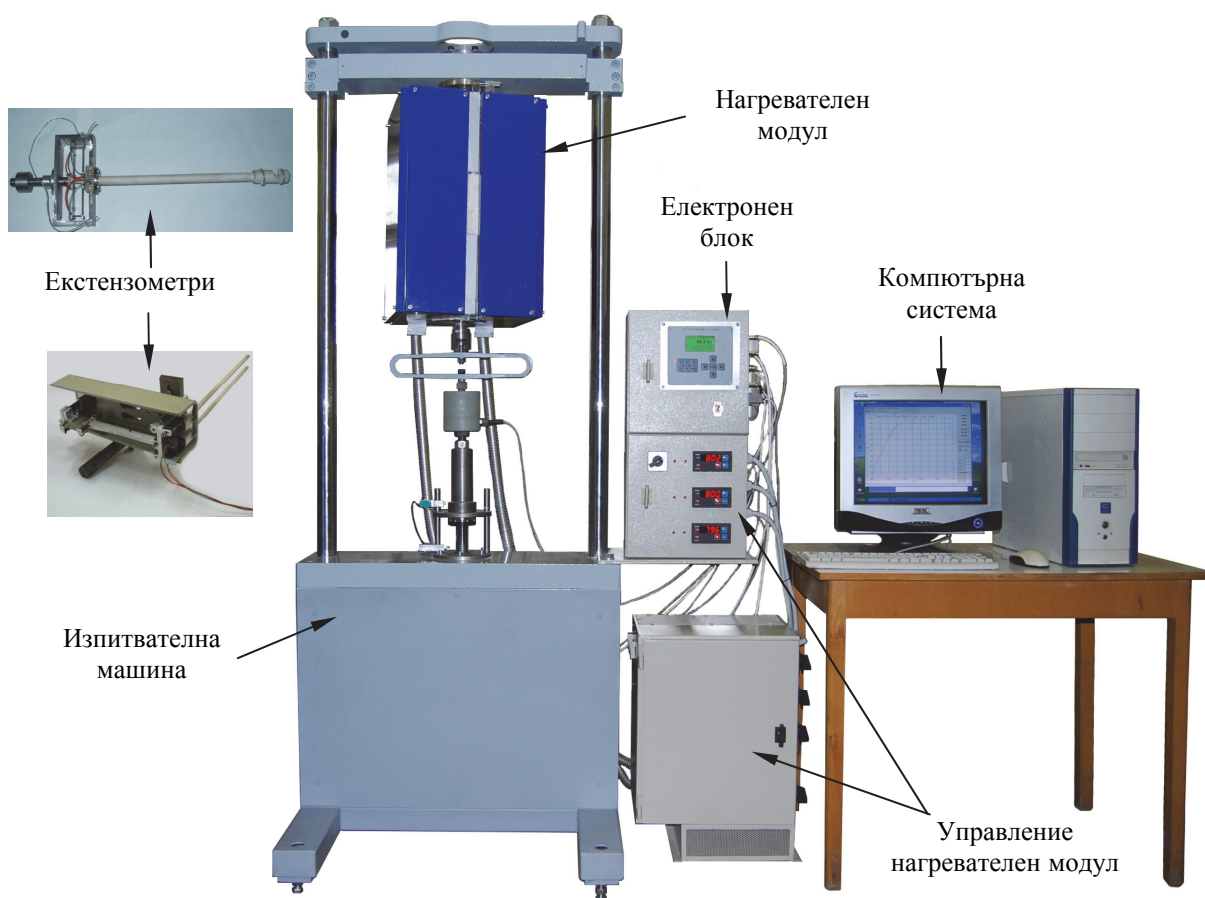
Фигура 43. Наличен стенд за изпитване на материалите при високи температури.
