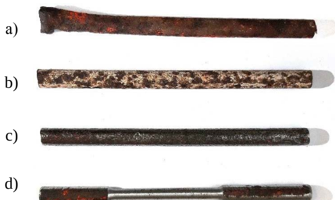
Фигура 34. Подготовка на корозирали пробни тела за изпитване на опън.
