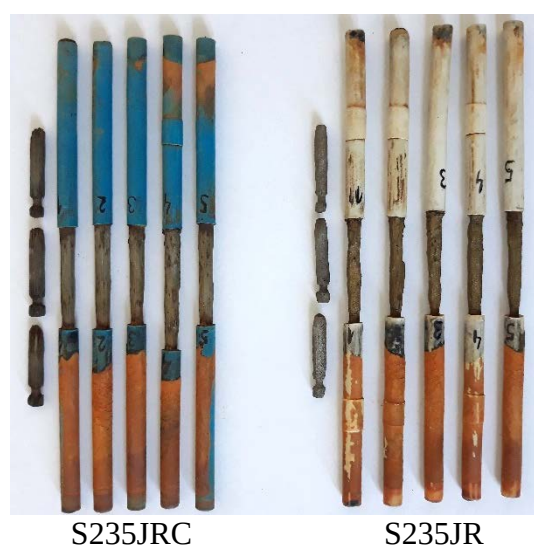
Фигура 47. Снимка на почистени пробни тела след 189 дни АІ-тест.
