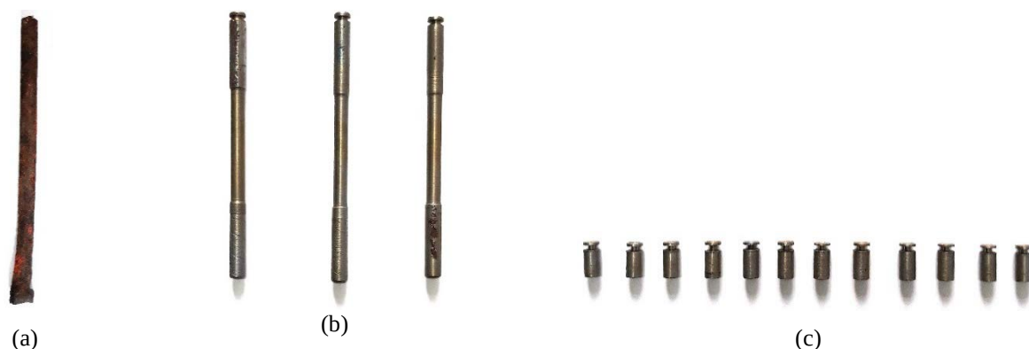
Фигура 36. Пробни тела: (a) Изходен материал; (b) Пробни тела за изпитване на опън; (c) Пробни тела за установяване на скоростта на корозия при АІ-тест.
