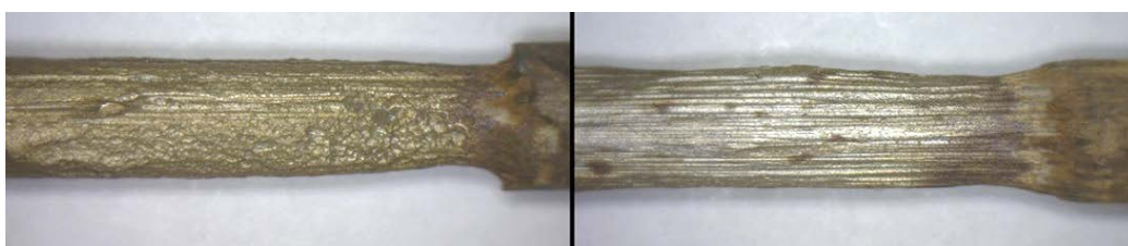
Фигура 48. Пробни тела след 189 дена AI-тест (S235JRC – отдясно, S235JR – отляво).
