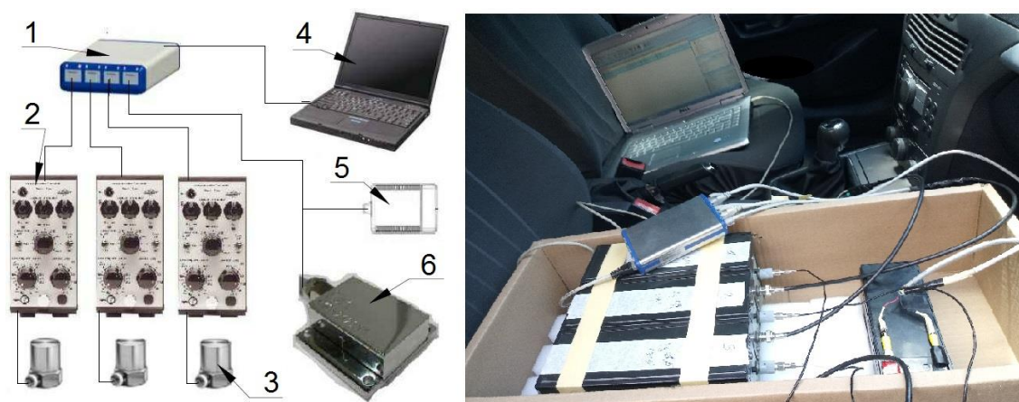
Фиг. 5.4. Измервателна схема: 1 – DAQ устройство, 2 – усилватели, 3 – пиезоелектрични акселерометри, 4 – регистриращо устройство (PC), 5 – зарядна батерия, 6 – капацитивен акселерометър.
