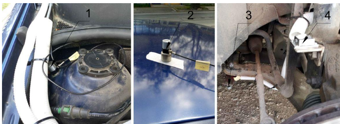
Фиг. 5.3. Точки на измерване, разположени върху елементите от окачването и каросерията: 1 – точка върху каросерията до горната опора на амортизатора, 2 – точка върху покрива, 3 – точка върху долното рамо, 4 – точка върху вертикална стойка (оста).
