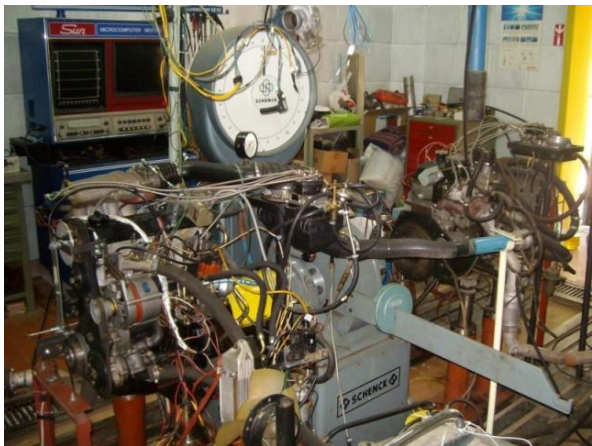
Фиг. IV.2. Общ изглед на спирачката с изпитвания двигател без турбокомпресор
