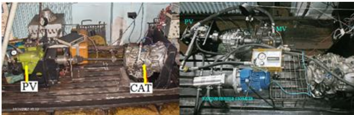
Фиг. 3.8. Изображения на участък от стенда, преди и след вграждане на двупоточен модул – ОХМП
