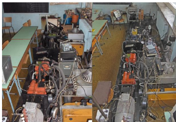
Фиг. 3.7. Стенд за изпитване, преди и след вграждането на двупоточния модул
