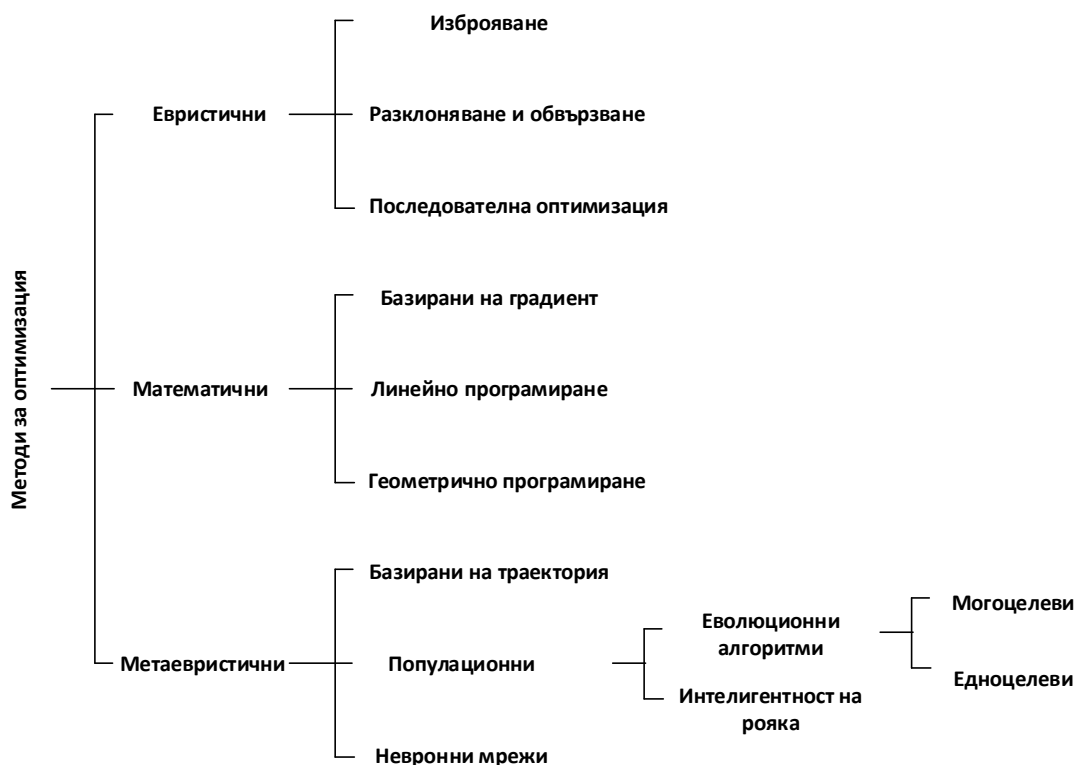
Фигура 5-1. Класификация на методите за оптимизация от гледна точка на тяхното прилагане за оптимално проектиране на силови електронни устройства
