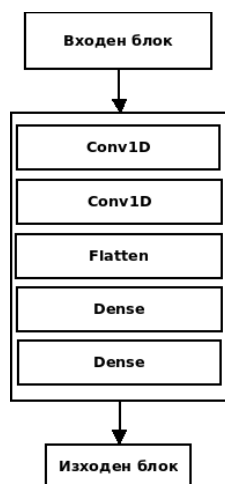
Фигура 3.12. Архитектура на CNN за анализ на P300 сигнали.
