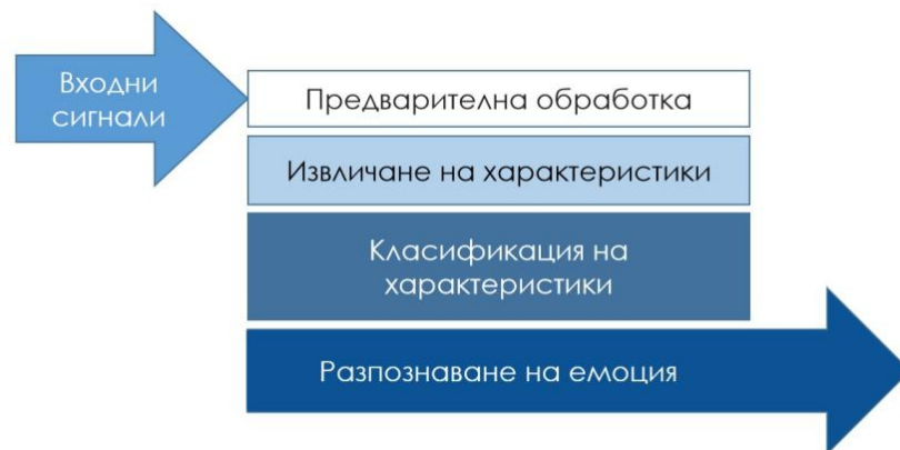
Фиг. 1-11 Блок диаграма на система за разпознаване на емоции
