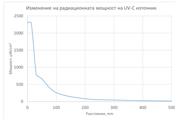
Фигура 2 6: Изменение на радиационната мощност на UV-C източник при отдалечаване
