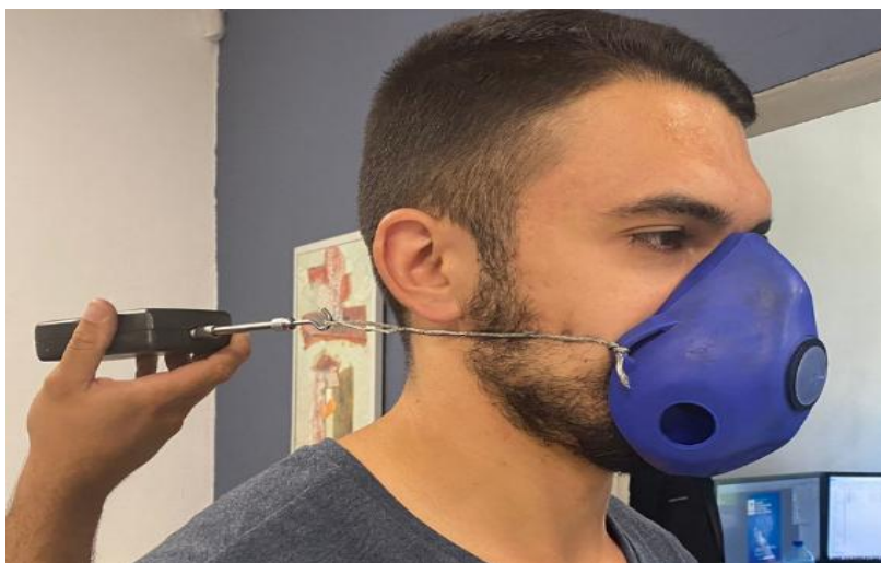
Фигура 2 1: Определяне на силата за притискане на маската към лицето
