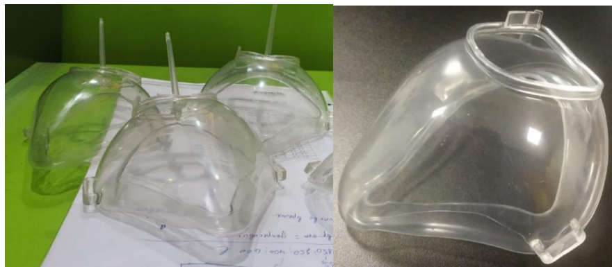
Фигура 7.17 Шприцформа за UV защитна маска. Готови детайли
