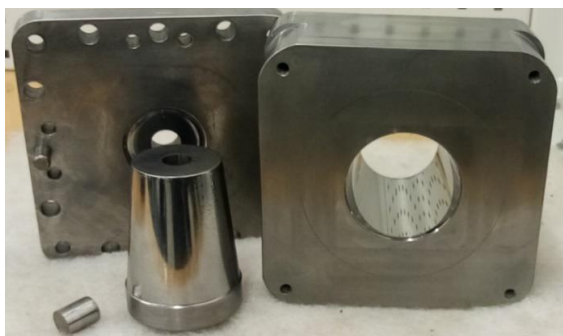
а. Формообразуващи преди монтаж
