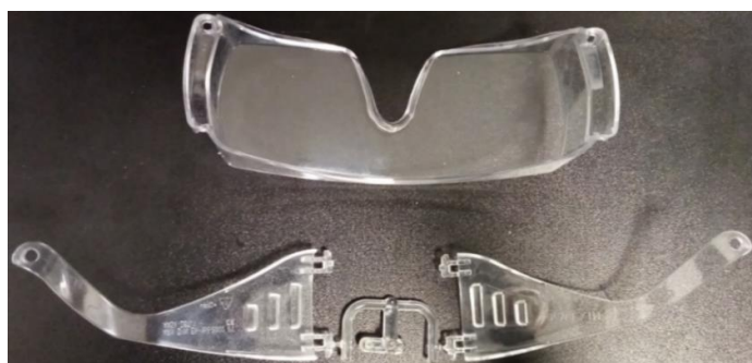
а. Комплект детайли след шприцване.
