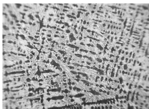
Фиг. 4.7 Състав II, микроструктура на мартензитна матрица и легиран ледобурит след T_{\text{ауст.}} = 1000^{\circ}\text{C} , 100min, x100
