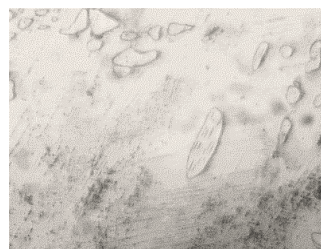
Фиг. 4.12 Състав II, карбиди Cr 7 C 3 , разположени в аустенитна матрица след Тауст. = 1200°C, 120min, x500
