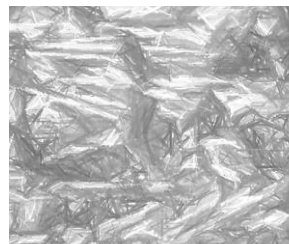
Фиг. 4.10 Състав II, микроструктура на мартензитна матрица и легиран ледобурит след T_{\text{ауст.}} = 1100^{\circ}\text{C} , 100min, x1000
