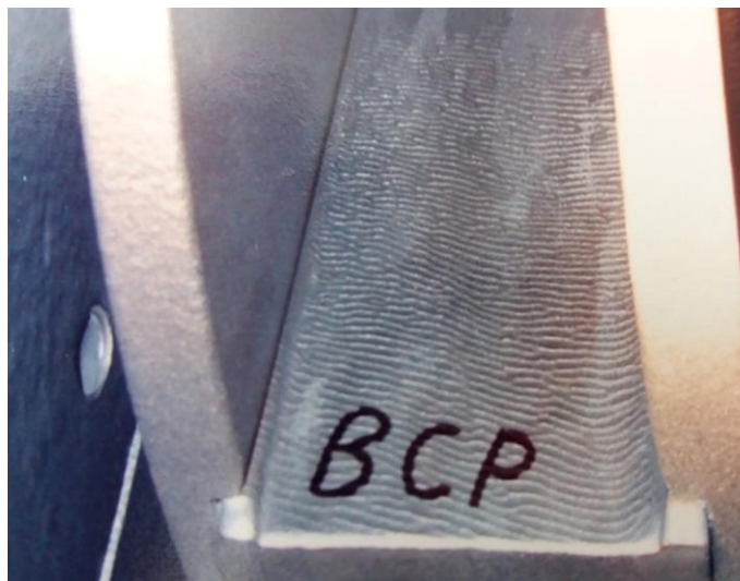
Фиг. 6. 4 Износване на лопатка от износоустойчив бял хром - никелов чугун ИЧХ28Н2 (ГОСТ 11849-76)
