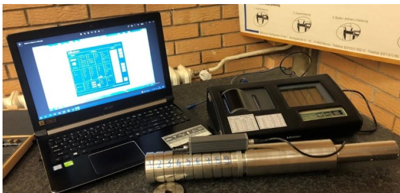
Фигура 4. 3 Измерване на грапавост с Mitutoyo SJ-310
