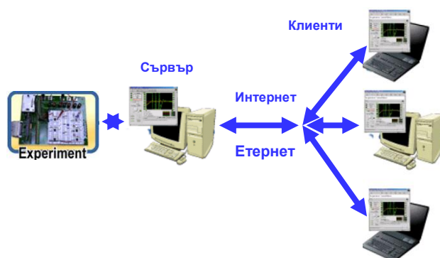
Фигура 3.3 Управление на експеримент през Интернет на отдалечена лаборатория
