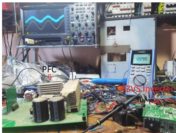
Фигура 17 Опитна постановка на изследване на изправител с подобрен фактор на мощност
