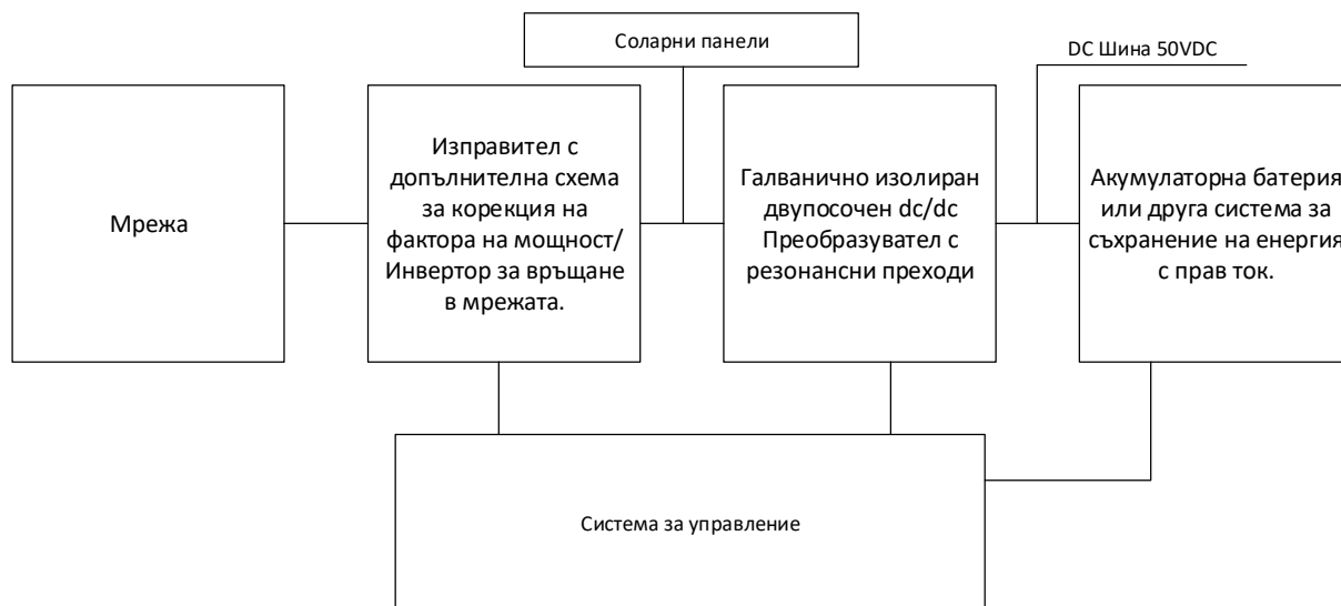
Фигура 8 Предложена топология на хибридна система
