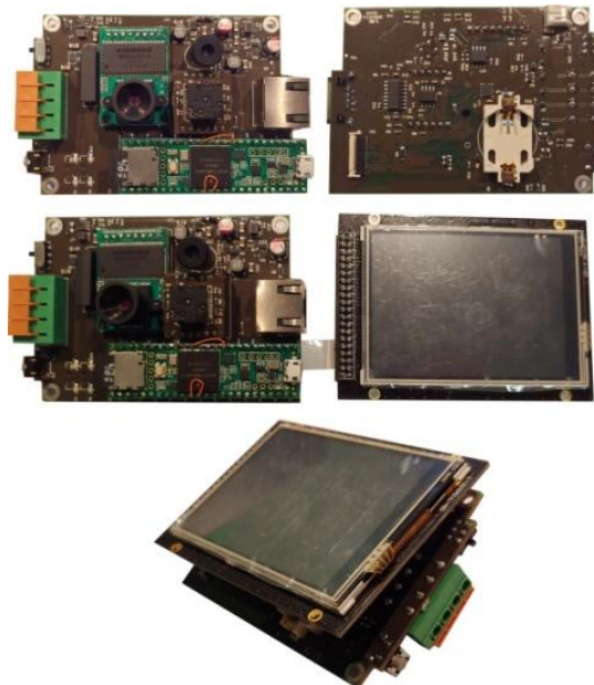
Фиг. 90. Прототип на разработената портативна система за инфрачервена диагностика
